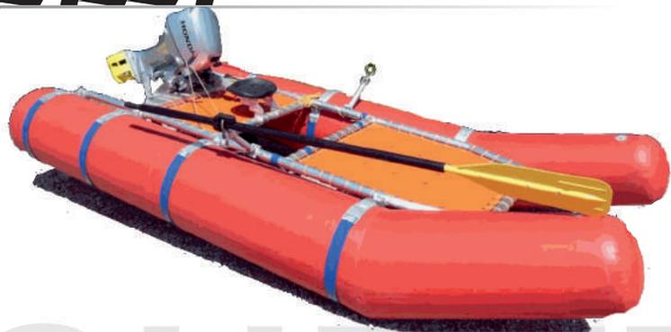
Fuoribordo da CV 20, con elica intubata, installato mediante un dispositivo di sollevamento rapido.
